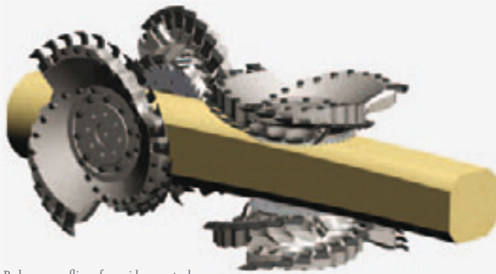
Reduceraren flisar fyra sidor av stocken.
